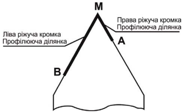
Рис. 1. Профілюючі ділянки різальних кромок дискової обкатної фрези
